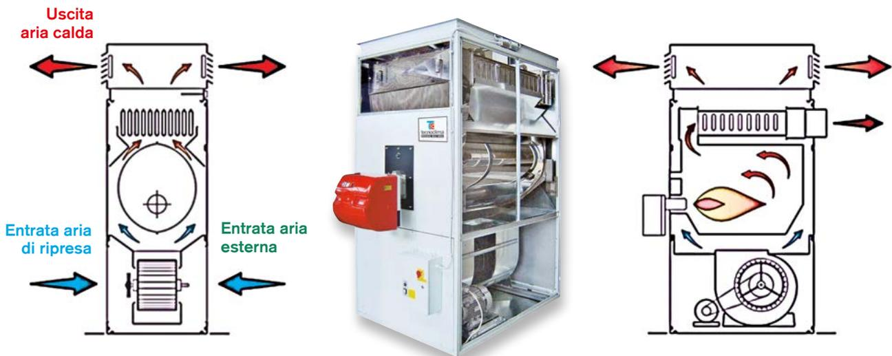
La peculiarità della tecnologia di **riscaldamento "dry"** è di trasferire direttamente ed immediatamente il calore prodotto dalla combustione nell'ambiente
