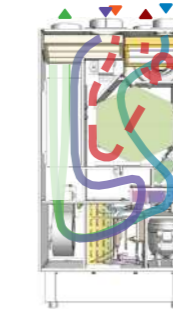
Flusso ricircolo, ricambio e trattamento aria
